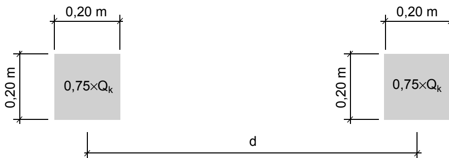
Figura 10 – Cargas concentradas para projeto de helipontos
